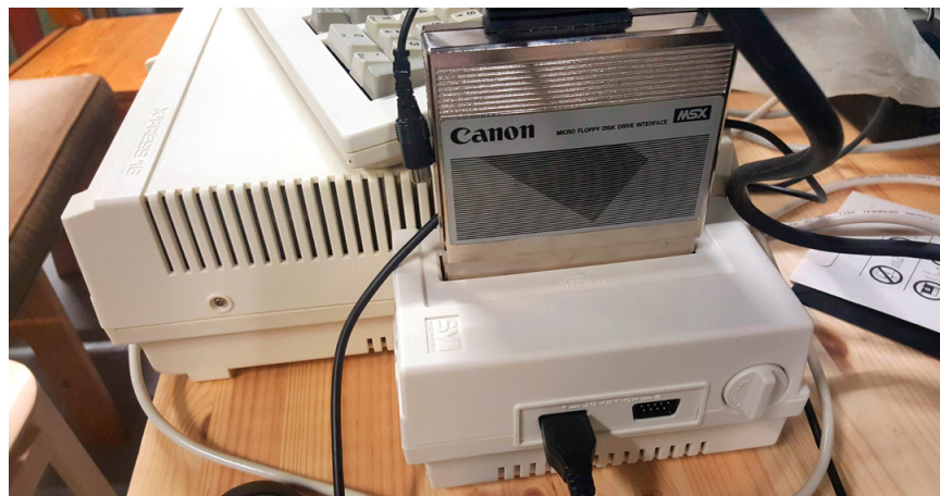
Ainoa tapa käyttää levyasemaa MSX:n puolelta on kytkeä moduliporttiin ulkoinen levyasemaohjain.
